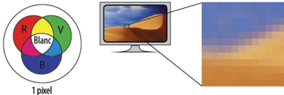
Dans un écran LCD (*Liquid Crystal Display*), les cristaux liquides placés devant des filtres rouges, verts et bleus, sont au départ alignés. Avec une modification du champ électrique, l'orientation des cristaux liquides va être modifiée pour modifier le passage de la lumière à travers les filtres colorés.
